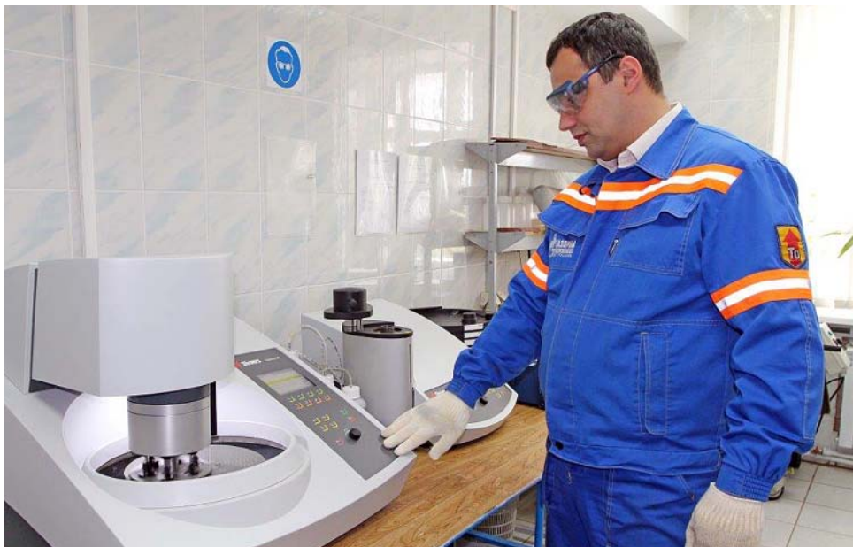
Ведущий инженер НИЛНТ ЦНИПР ГПУ П. Шапошников за работой на полировально-шлифовальном станке
