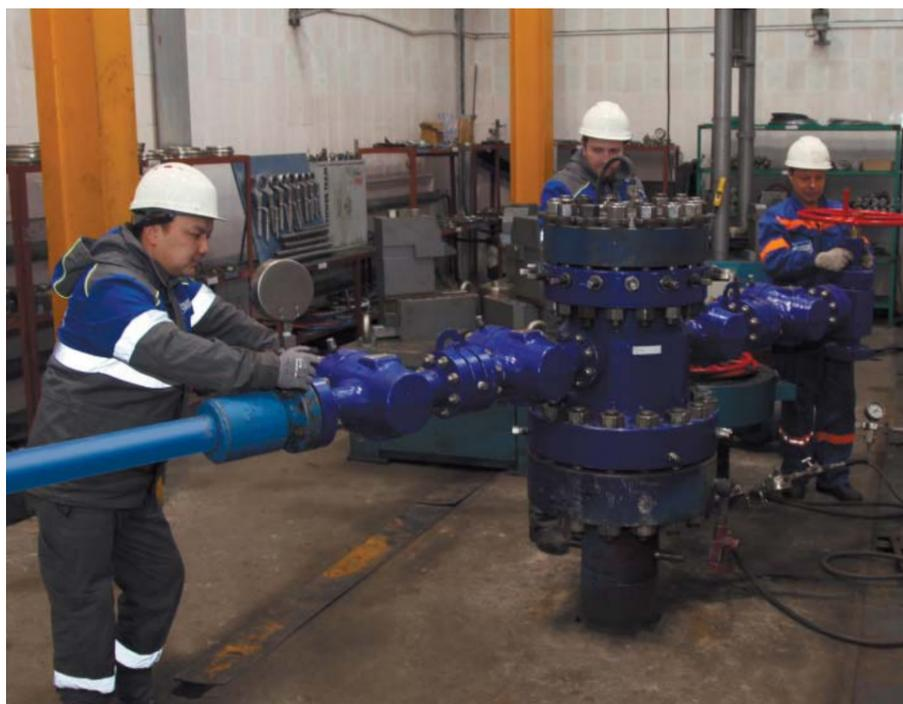
Слесари-ремонтники (слева направо Р. Сисенов, Е. Гладун, А. Помогаев) проводят испытания на герметичность трубной головки фирмы «Корвет»
