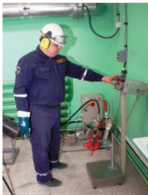
На участке по техническому обслуживанию, ремонту, зарядке и испытанию огнетушителей работа специалистов по зарядке порошкового огнетушителя занимает около 30 минут, углекислотного – 20 минут
