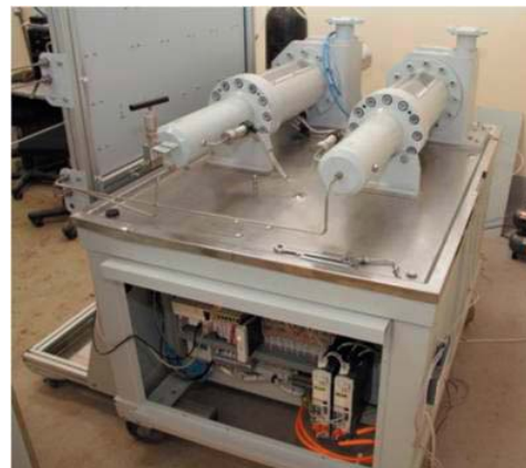
Экспериментальные термодинамические исследования компанией ООО «Газпром ВНИИГАЗ» выполнялись на ртутной установке фазовых равновесий ARNOULIN SERMIP FRANCE
