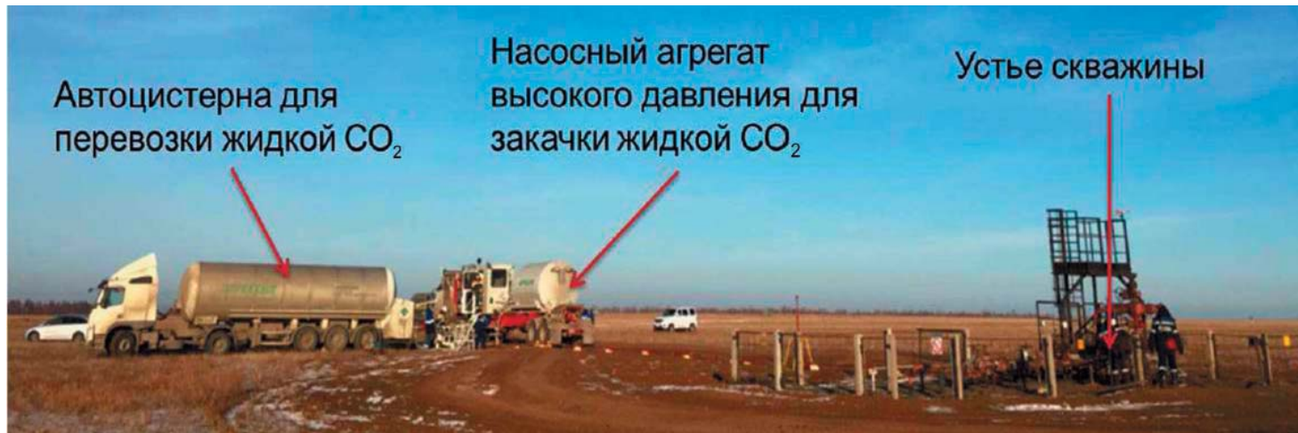
В 2019 году планируется проведение опытно-промышленных работ по закачке CO_2 для снятия конденсатной блокировки скважин АГКМ
