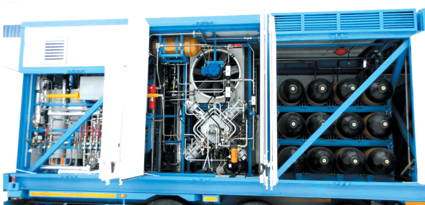
Передвижной автомобильный газовый заправщик (ПАГЗ) предназначен для заправки транспортных средств компримированным природным газом (КПГ) в местах, не оборудованных стационарными АГНКС
