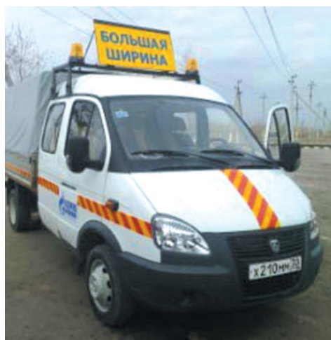
Транспортное средство, оборудованное для сопровождения перевозки крупногабаритных и тяжёловесных грузов
