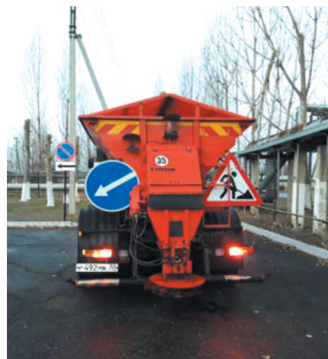
Машина дорожная комбинированная для обслуживания и уборки дорог в зимний период
