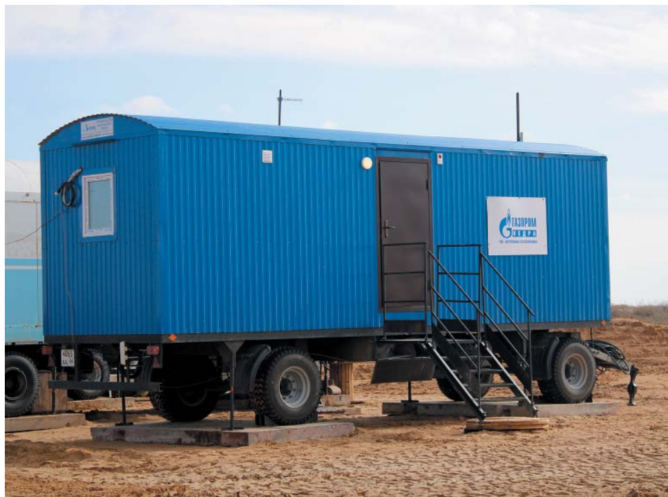
Внешний вид станции геолого-технических исследований
