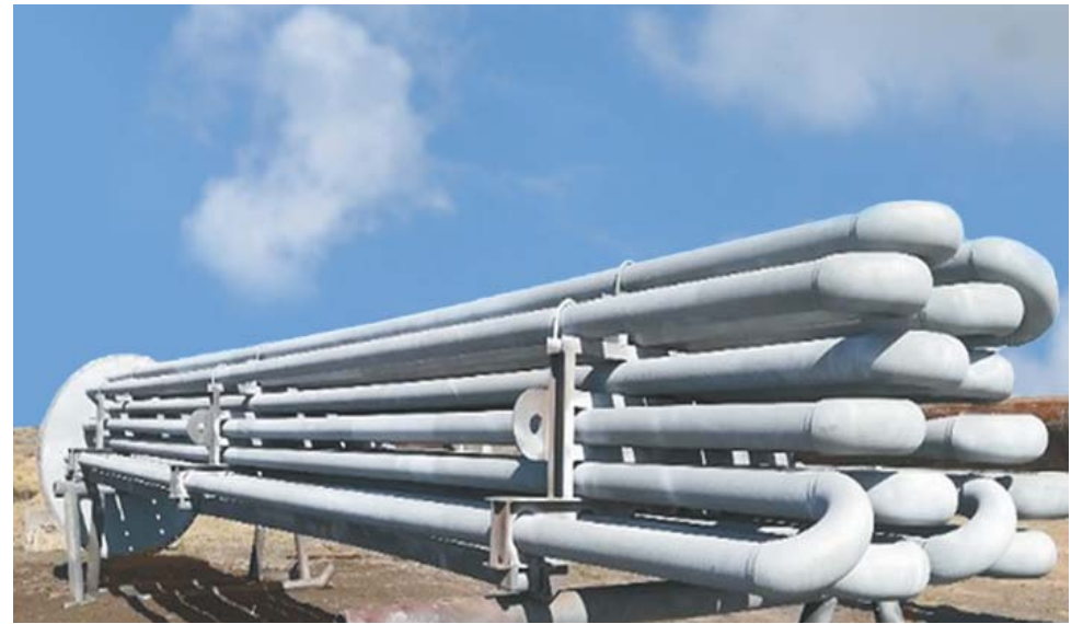
Змеевик подогревателя ГЖС с нанесённым защитным металлизированным покрытием
