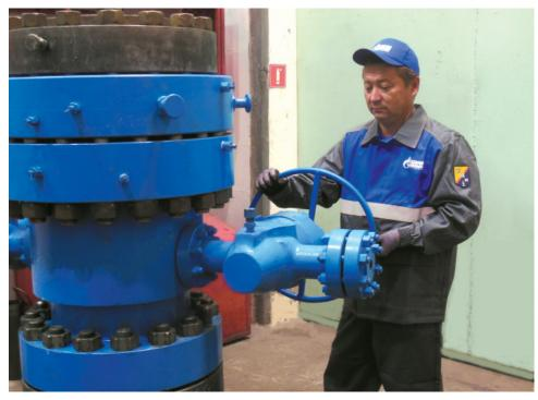
Тимур Сапралиев проводит испытания колонной головки
