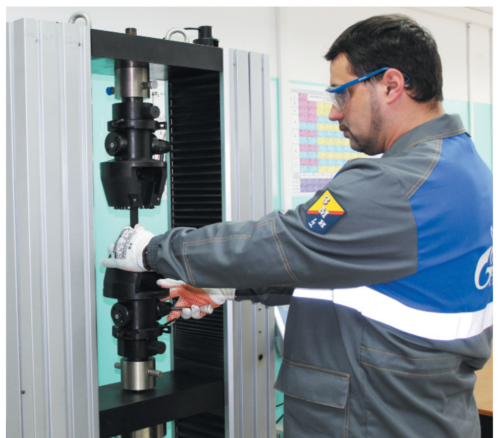
Ведущий инженер научно-исследовательской лаборатории новой техники ЦНИПР Павел Шапошников проводит испытания образцов на растяжение
