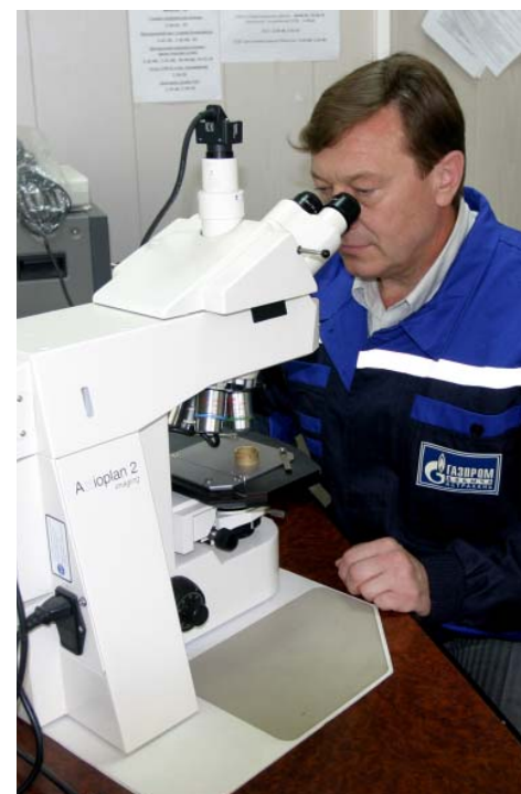
Оценка микроструктуры образца металла на универсальном микроскопе
