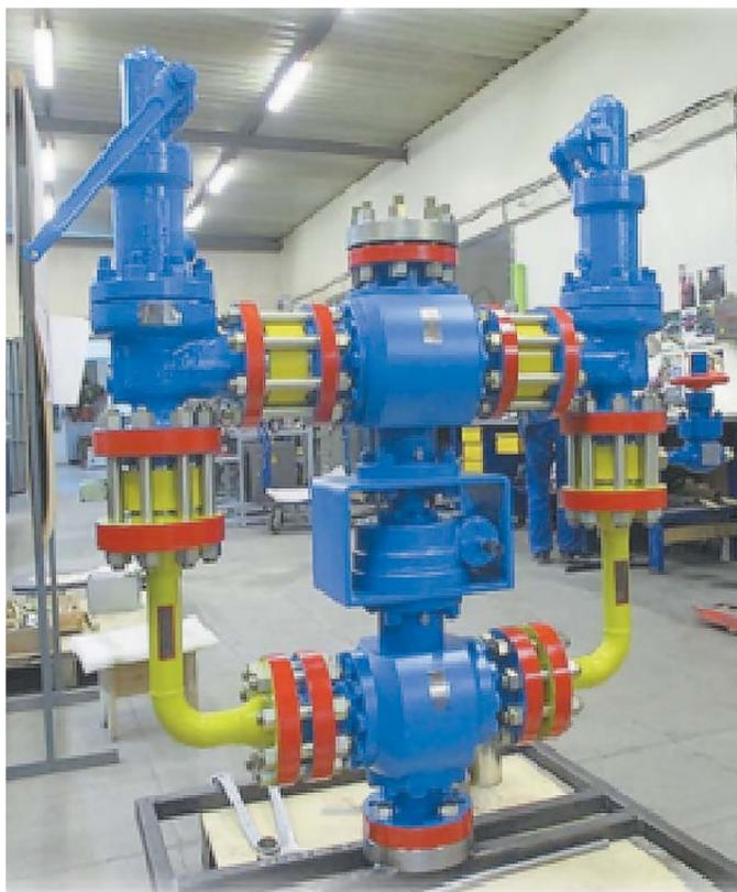
Инновационный блок регуляторов давления предохранительных клапанов
