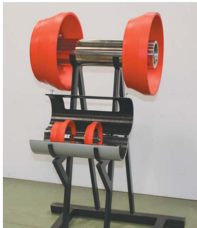
Поршень для проведения ингибирования газоконденсатопроводов и продукционных линий
