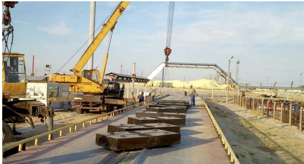
Проверки автомобильных весовых комплексов У250 АГПЗ с применением эталонных грузов
