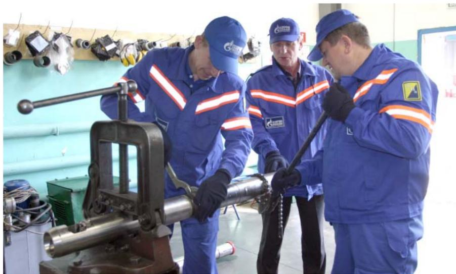
Демонтаж замкового соединения клапана-отсекателя ЦРПО
