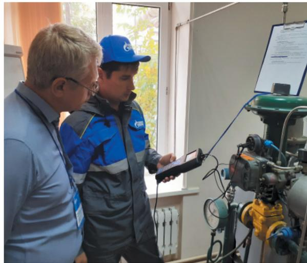
Тренажерный комплекс «Автоматическое регулирование и мониторинг работы добывающей газовой скважины» в 2018-2019 годах прошел глубокую модернизацию. В схему интегрировали современные программно-логический контроллер и графический терминал, системы искро- и молниезащиты. Были разработаны методические рекомендации, сценарии проведения работ, выполняющихся при возникновении нештатных, аварийных ситуаций.
