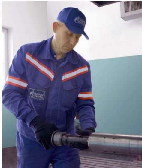
Подготовка замка к установке спускового устройства
