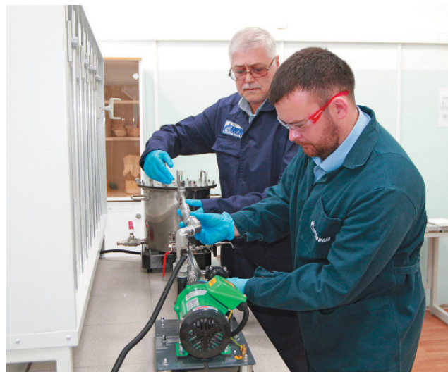
Сборка новой установки Монитор-стенд для определения защитных свойств ингибитора коррозии
