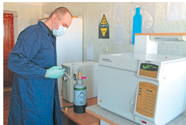
Подготовка к введению поверочной газовой смеси
