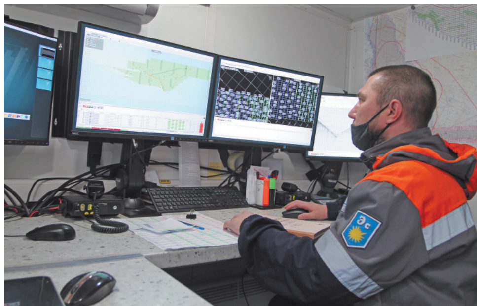
Регистрация показателей упругих колебаний на передвижной сейсмостанции
