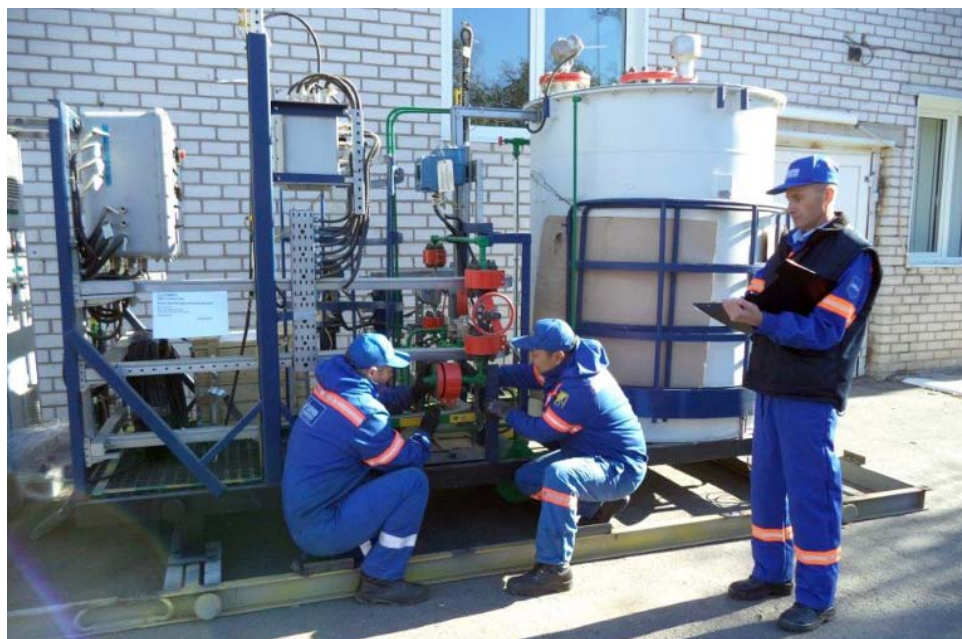
Начальник участка РТОиИЗЧ МРС ГПУ Александр Зимин (справа), слесари-ремонтники участка Ринат Сисенов и Евгений Гладин проводят входной контроль блочно-модульного комплекса дозирования реагентов
