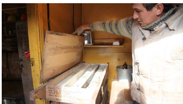
После извлечения керновой материал отмывается водой и складывается для хранения в специальные ящики
