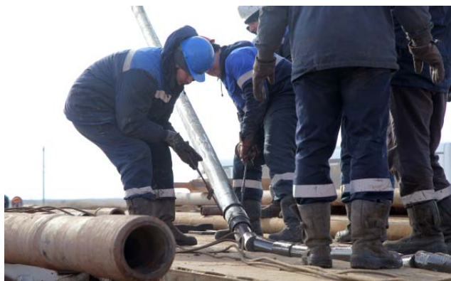
При работах на буровой № 916 используется керноотборный снаряд СК 178/100 «Триас», отличающийся надёжностью и удобством эксплуатации
