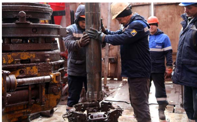
При работах на буровой № 916 используется керноотборный снаряд СК 178/100 «Триас», отличающийся надёжностью и удобством эксплуатации
