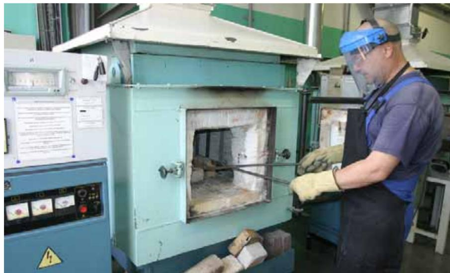
Извлечение закалённой заготовки
