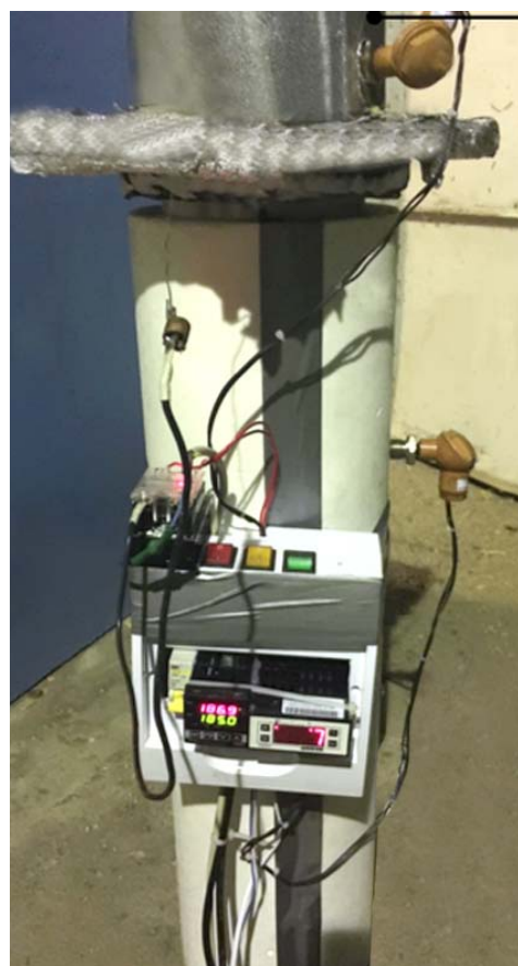
Опытная установка грануляции серы с контактной охлаждающей поверхностью
